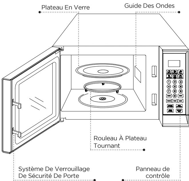
**REMARQUE:** Ne retirez pas la plaque de mica qui recouvre le guide d'ondes dans la cavité du four.
